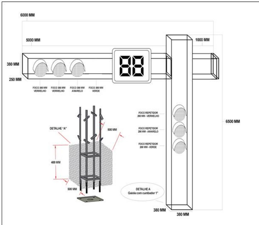
A fixação dos módulos semafóricos junto ao Pórtico deverá ser do tipo encaixe, e com suas travas desenvolvidas de modo que fiquem escondidas a visualização do usuário.
